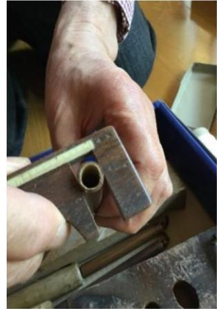
玉尺で軸の太さを測る
