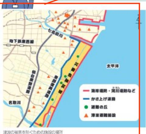
津波の被害を防ぐための施設の場所
