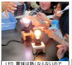
LED 電球は熱くならないので, 触れるが白熱電球は熱いので, 触ることができない。
