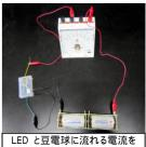
LED と豆電球に流れる電流を 測るために単三電池2本直列 (3V)で実験した
