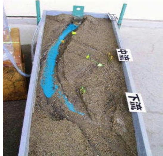
市販の流水モデル実験器（中村理工工業社製RW-B型 全長1400mm、全幅50mm）では、使用条件を整えることによって、流水の三作用について観察することができるとされている。滞水部（海洋を模した部分）があるために、川の上流から河口、さらには沖合海底までを模すことができ、入れる土砂の粒度構成（粒の大きさ）を吟味することで、扇状地、河岸段丘、デルタ（河口の三角州）などの地形に類した表面形態をつくることもできるとされている。
