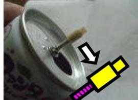
空き缶の底部から4cm程度の高さまで帯状に200こ程度虫ピンで穴を開ける。
