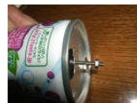
虫ゴムをネジに押し込んでかぶせ、虫ゴムの先端をたごませる。
