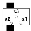
コース (右にずれた状態) s3 s2 s1  $センサ入力(INP) = (0 1 0)_2 = _______ [s1 = 0 , s2 = 1 ] なので , <u>制御データは「左へ軌道修正」</u>$
