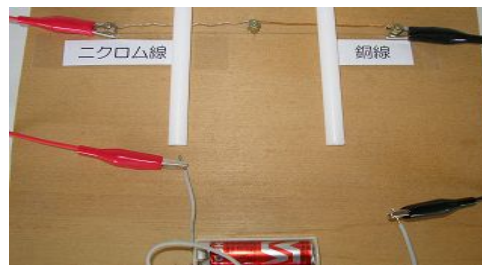
図6 電流による発熱実験①
