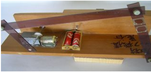
図9 回転運動を変換する模型
