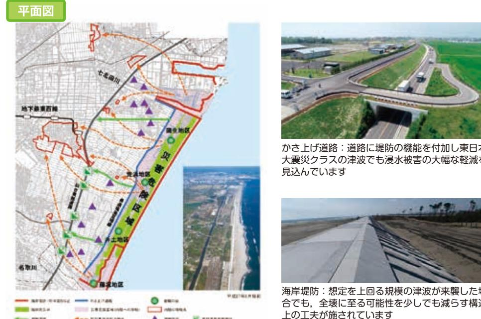
かさ上げ道路：道路に堤防の機能を付加し東日本大震災クラスの津波でも浸水被害の大幅な軽減を見込んでいます
